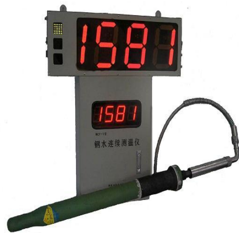
图 2 黑体空腔钢水连续测温系统照片
